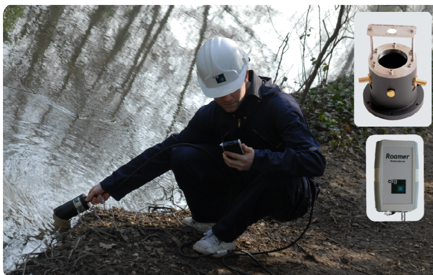
Основная: UviLux с использованием КПК Вставки: проточная ячейка, беспроводной роутер
